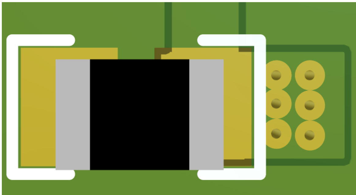
图 3-9. 大型无源器件和很多过孔
