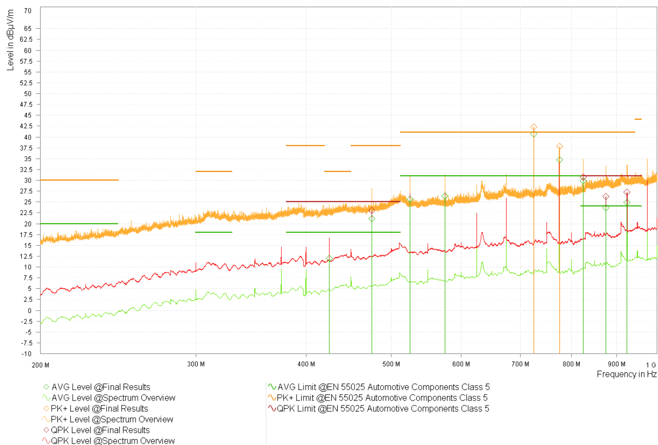
图 3-15. 型号 3 LMK3C0105-Q1 3.3V 频谱概述 - 对数周期
