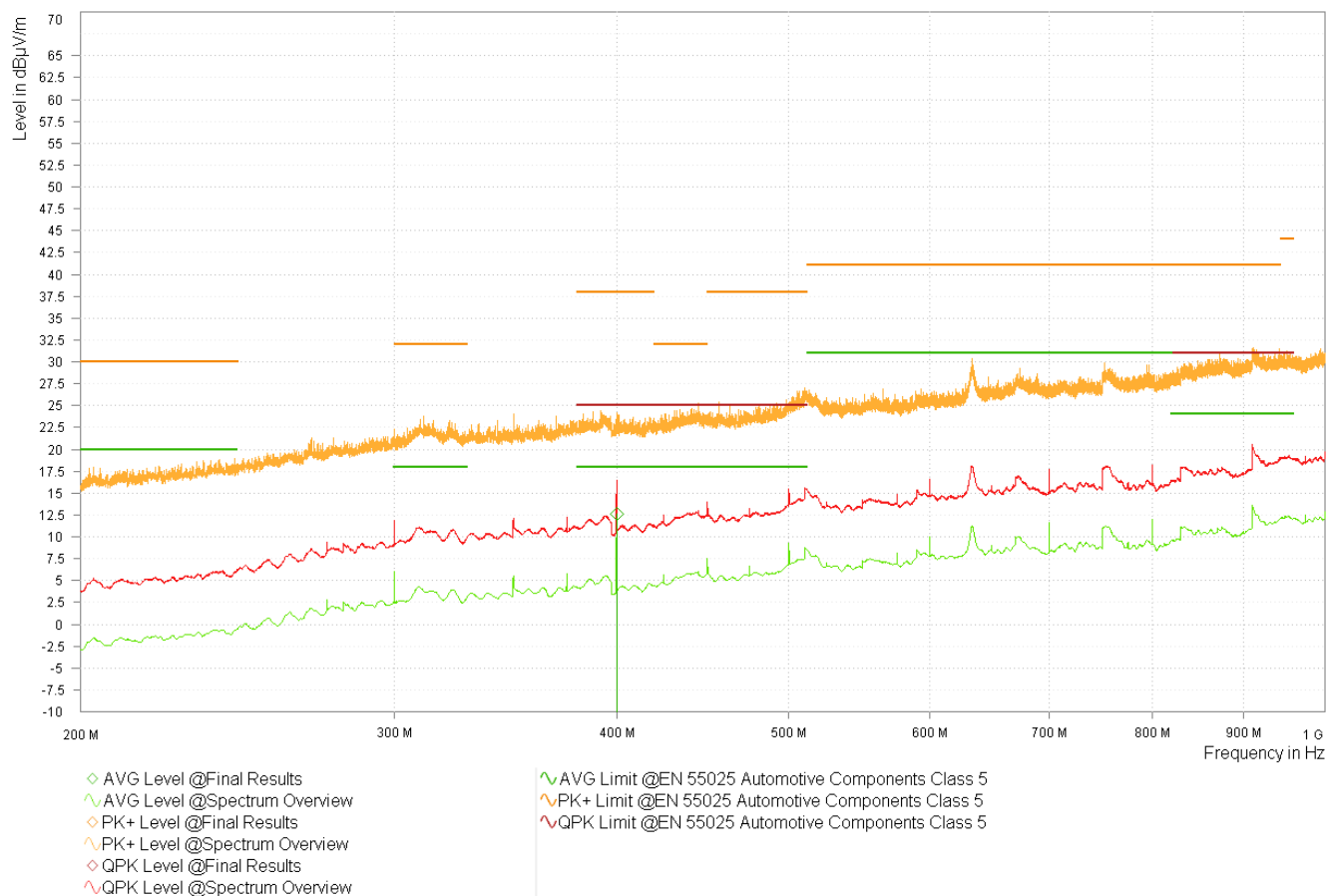
图 3-14. 型号 2 LMK3C0105-Q1 3.3V 频谱概述 - 对数周期
