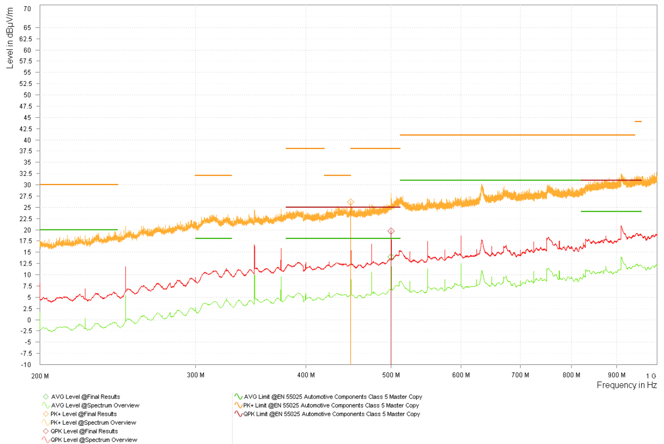
图 3-19. 竞品振荡器 3.3V 频谱概述 - 对数周期
