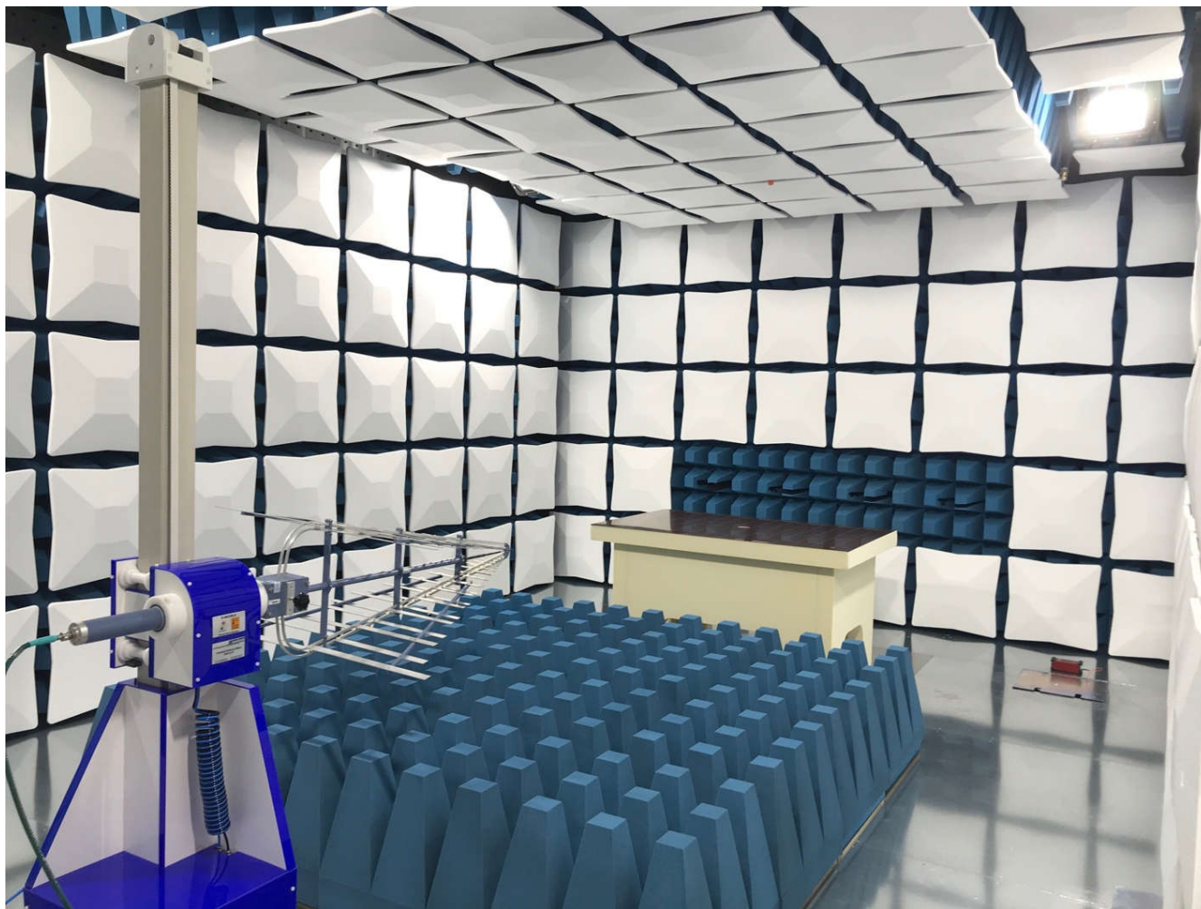
图 4-1. CISPR-32 测试室设置
