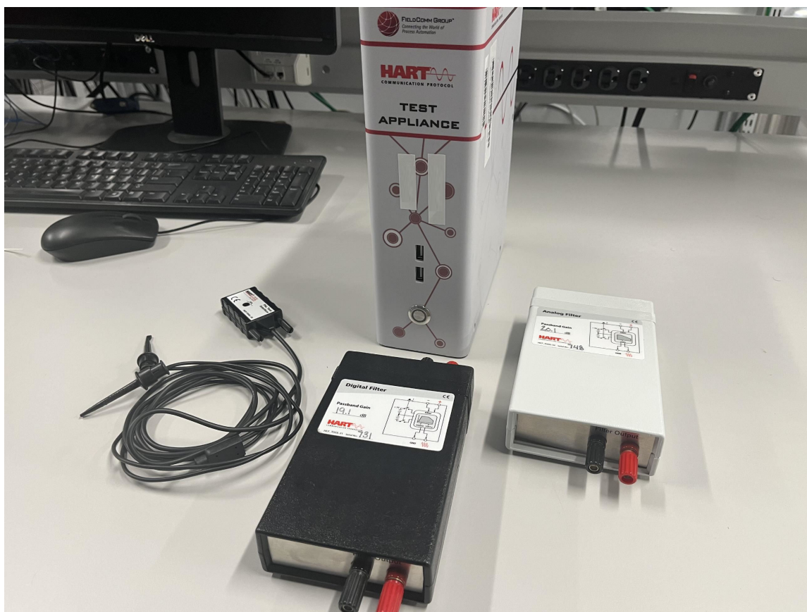
图 3-1. 具有 HCF_TOOL-31、HCF_TOOL-32 和 FSK 物理测试接口的 HART 测试系统
