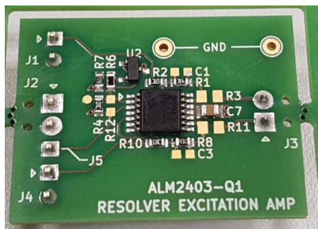
图 2-2. 采用 ALM2403-Q1 (基本电路) 的旋变激励放大器
