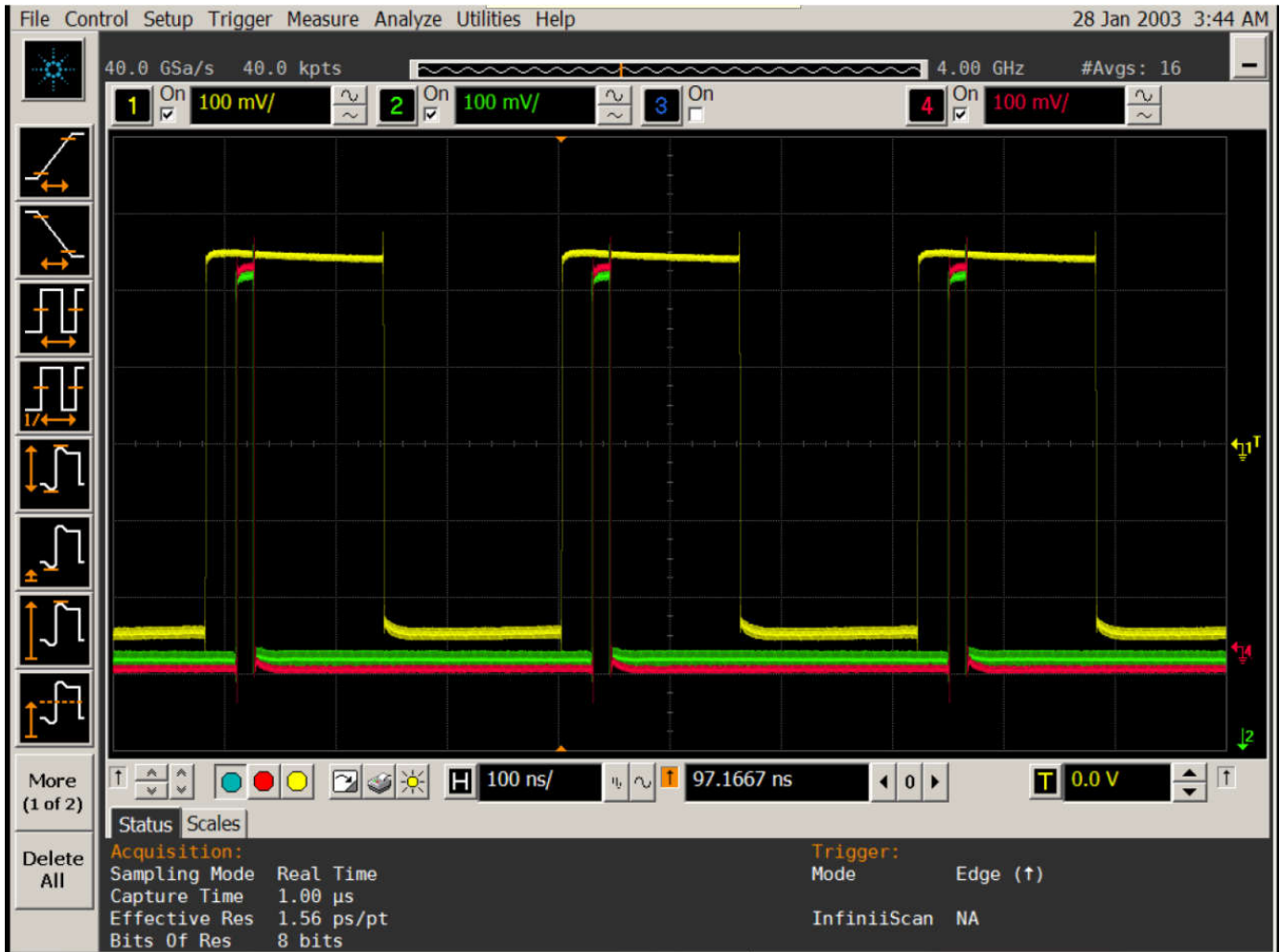
图 4-1. Primary 处于连续模式时，Secondary1 和 Secondary2 在脉冲模式下的同步波形。
