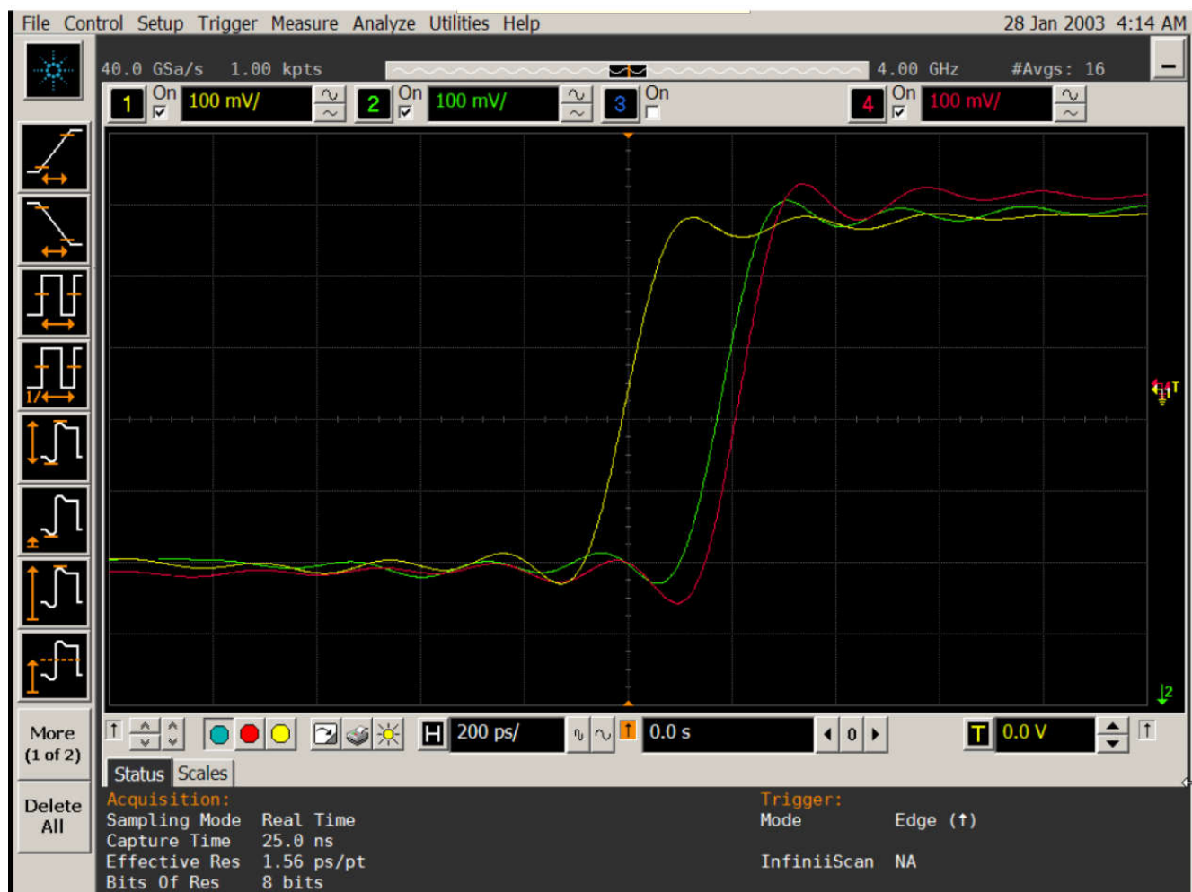
图 5-2. 主要处于连续模式的中继器非同步模式下 Secondary1 和 Secondary2 的波形 (放大后)
