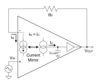
图 1-2. 电流反馈的简化图
