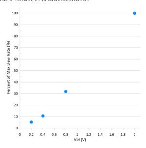
图 2-5. 压摆率与输入差分电压之间的关系
