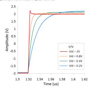
图 2-4. OPA690 在不同输入电压和增益下的脉冲响应
