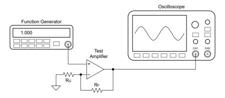
图 2-1. 用于实验室测试的设置
