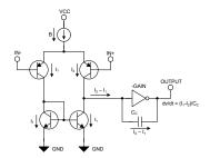
图 1-1. 显示压摆率 (v/dt) 的运算放大器简化图
