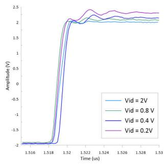
图 3-2. OPA695 的脉冲响应情况展示了不同输入电压和增益下的压摆率
