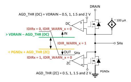
Figure 9. SHX OUT 比较器图示
