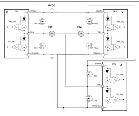
Figure 6. 级联桥配置
