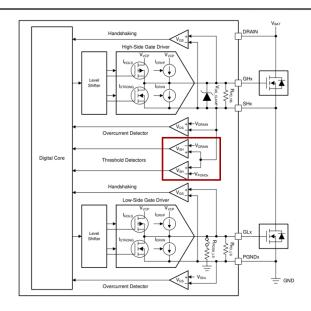
Figure 8. DRV8714/ DRV8718 驱动级内部功能框图
