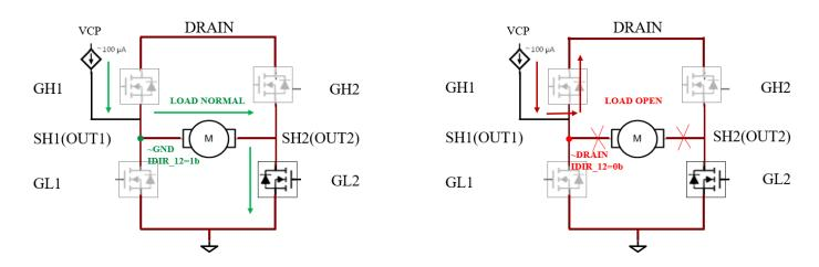
Figure 10. 负载正常与开路状态下 IDIR XX 输出比较
