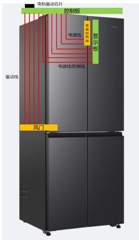
图 1 冰箱结构示意图
