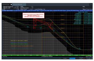
图 5-6. 10MHz 基准输入至 LMX2820 1GHz 输出,带或不带缓冲器(用例 1: T1 至 T3,用例 2: T4 至 T6,输入功率:-6dBm、5dBm、10dBm)
