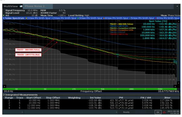
图 5-1. LMK1C110x 在源和缓冲器之间的 10MHz 输出相位噪声差
