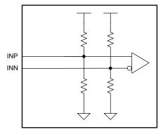
图 4-1. 内部直流偏置失调电压架构
