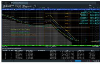
图 5-12. 总 RMS 抖动(10Hz 至 50MHz): 10MHz 基准输入至 LMX2820 100MHz 输出,带或不带缓冲器(用例 1: T1 至 T3,用例 2: T4 至 T6,输入功率: -10dBm、0dBm、14dBm)
