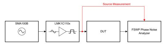
图 6-2. 加性噪声缓冲器设置
