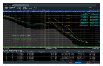
图 5-9. 总 RMS 抖动(12kHz 至 20MHz):10MHz 基准输入至 LMX2820 1GHz 输出,带或不带缓冲器(用例 1:T1 至 T3,用例 2:T4 至 T6,输入功率:-6dBm、5dBm、10dBm)
