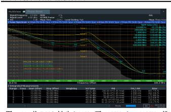
图 5-13. 总 RMS 抖动(10Hz 至 50MHz): 10MHz 基准输入至 LMX2820 1GHz 输出,带或不带缓冲器(用例 1:T1 至 T3,用例 2:T4 至 T6,输入功率:-6dBm、5dBm、10dBm)
