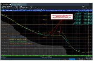
图 5-4. 100MHz 基准输入至 LMX2820 1GHz 输出,带或不带缓冲器(用例 1:T1 至 T3,用例 2:T4 至 T6,输入功率:-6dBm、5dBm、10dBm)
