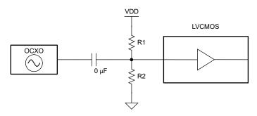
图 4-5. 重新偏置到 LVCMOS 电平
