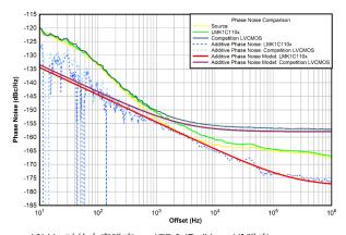
10kHz 时的本底噪声 = -177.9dBc/Hz、1/f 噪声 = -164.3dBc/Hz
