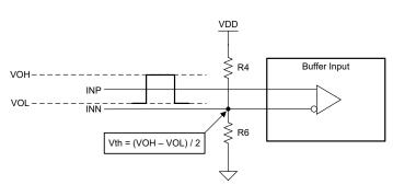
图 4-9. 具有差分输入级的直流耦合单端输入
