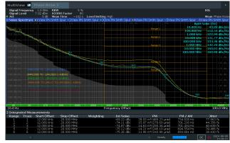
图 5-10. 总 RMS 抖动(12kHz 至 20MHz): 100MHz 基准输入至 LMX2820 1GHz 输出,带或不带缓冲器 (用例 1: T1 至 T3,用例 2: T4 至 T6,输入功 率:-6dBm、5dBm、10dBm)
