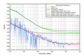
10kHz 时的本底噪声 = -181.9dBc/Hz、1/f 噪声 = 178.5dBc/Hz
