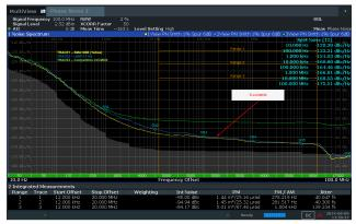
图 6-9. RMS 抖动(12kHz 至 20MHz):100MHz 输 出 - LMK1C110x 与竞品比较
