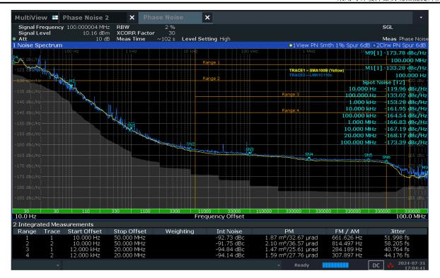
图 5-2. LMK1C110x 在源和缓冲器之间的 100MHz 输出相位噪声差
