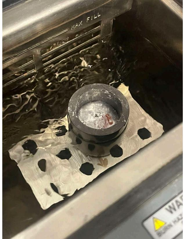
图 2-3. 装有液态镓的坩埚放置在油浴中
