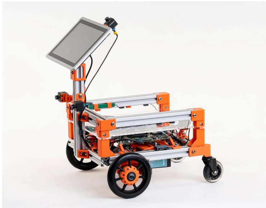
图 2. 具有底盘的 TechNexion “Rovybot” AMR 演示 (ROVY-4VM-EVK)
