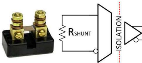
图 1. 基于分流器的隔离式电流检测
