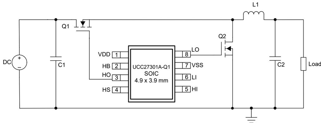
图 4-1. 具有 UCC27301A-Q1 的同步降压转换器
