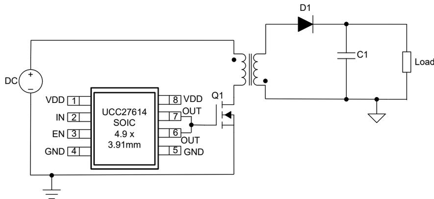
图 4-2. 具有 UCC27614 的反激式转换器
