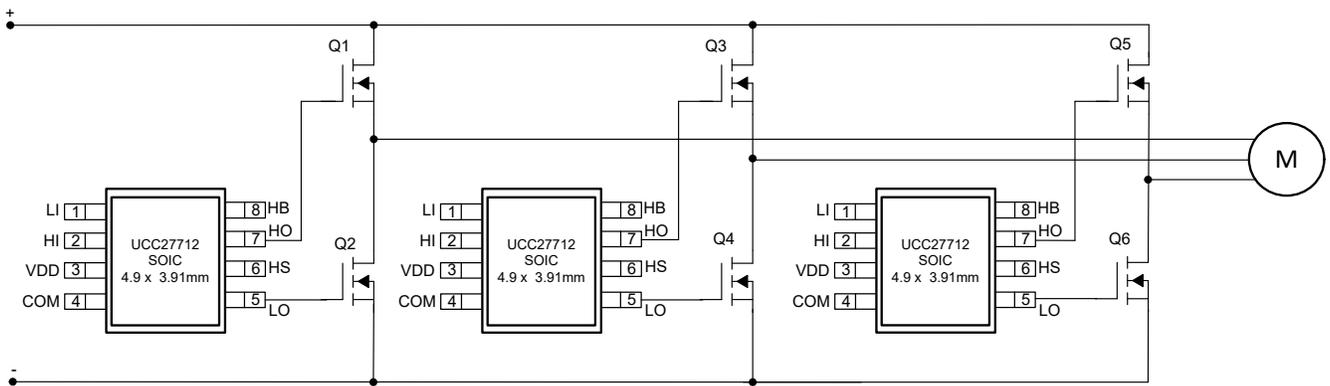
图 3-1. 具有 UCC27712 的三相逆变器电机驱动器
