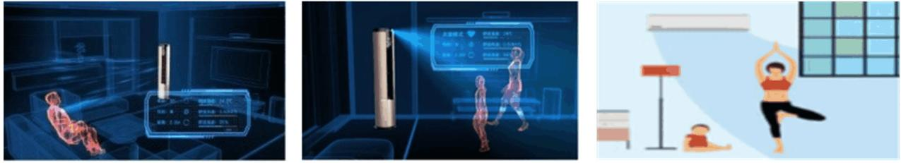
图 3-2. 使用毫米波进行定位
