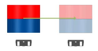
图 2. 使用两个传感器进行多位置检测
