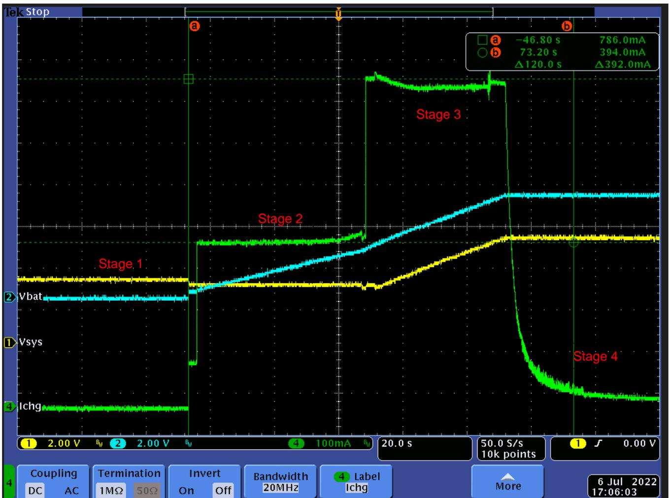
**Figure 9. BQ25798+TPS25221 测试波形**
