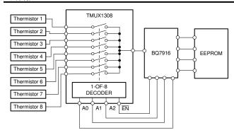
图 3. 整个系统中的 BQ79616-Q1 方框图
