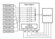
图 1. TMUX1308 多路复用器在电池管理系统中扩展 BQ79616 GPIO
