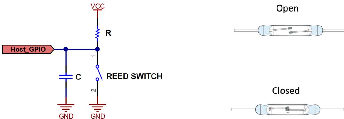
图 2-1. 簧片开关和简单电路
