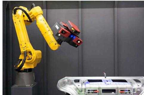
图 1. 安装在机械臂上的 3D 扫描仪
