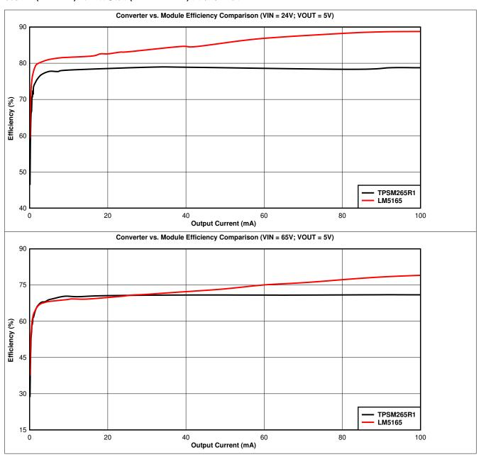
电源模块具有一个内部电感器,选择该电感器时考虑了数据表规格指定的输出电压范围内的稳定性和最大电流负载。尽管电源模块可以简化电源设计,并且使客户无需选择功率电感器,但与转换器相比,电源模块对设计的优化更少。在某些情况下(例如 TPSM53604 模块),电源模块可以具有与转换器相似的效率性能。通常,电源模块是为典型的输出电压轨量身定制的。
