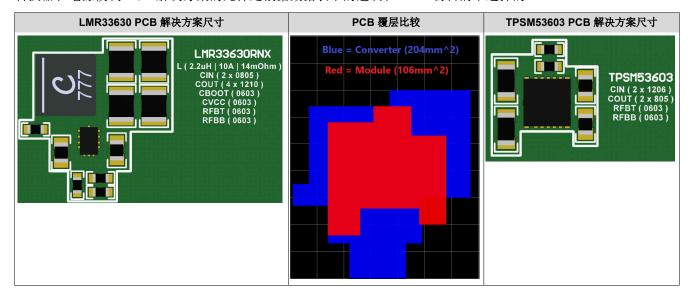
LMR33630 转换器电路的总解决方案尺寸经测量约为 204mm<sup>2</sup>, 而 TPSM53603 模块电路的总尺寸为 106mm<sup>2</sup>。
