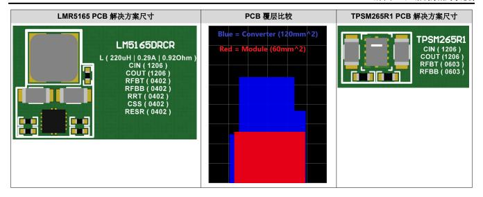
LMR5165 转换器电路的总解决方案尺寸经测量约为 120mm<sup>2</sup>, 而 TPSM265R1 模块电路的总尺寸为 60mm<sup>2</sup>。
