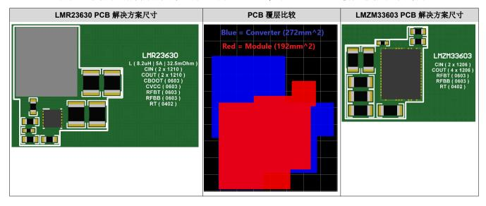
LMR23630 转换器电路的总解决方案尺寸经测量约为 272mm<sup>2</sup>, 而 LMZM33603 模块电路的总尺寸为 192mm<sup>2</sup>。
