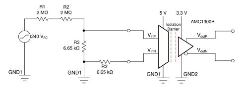
如下图所示,当现成的电阻器用于 R3 和 R3' 时,电路性能仍然非常好。输入端的增益误差从 18.2% 降至 0.3%。输出端的增益误差从 19.9% 降至 0.4%。输入端的偏移误差降至  $195\mu V$ ,输出端的偏移误差降至 2mV。
