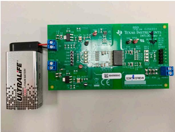
图 5. 使用电池的 ISOW7741DFMEVM 发射测试设置
