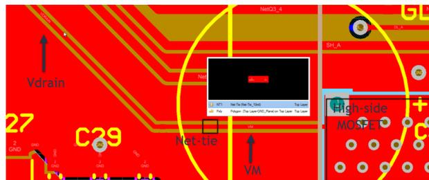
图 6-14. 网带连接组件高侧 MOSFET 漏极
