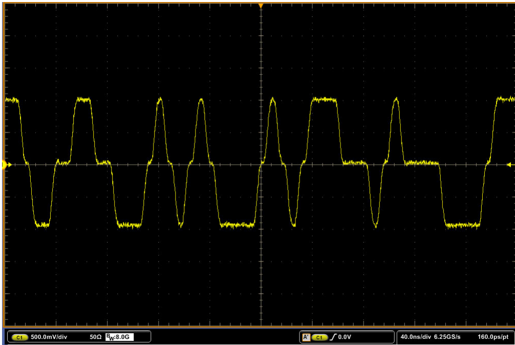
图 2-9. DP8386x 扰码空闲输出波形 100M (测试模式 5)
