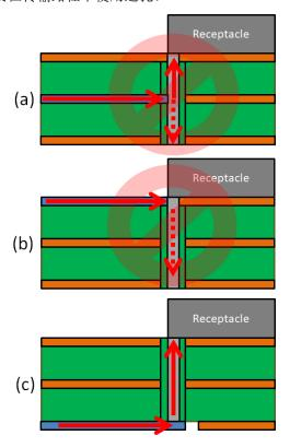
(a): 信号来自 PCB 的中间部分 (b): 信号来自 PCB 的顶部 (c): 信号来自 PCB 的底部
