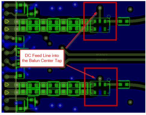
图 8-3. 之前实施的方案:直流馈线进入平衡-非平衡变压器的中心抽头
