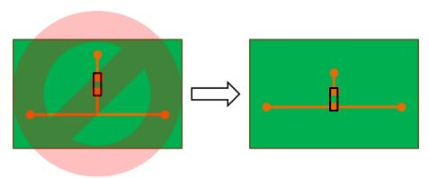
图 11-8. 使用:长度减小的残桩
