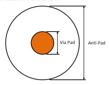
图 11-9. 过孔反焊盘
