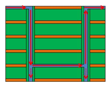
图 11-6. 必要时使用:具有短残桩的过孔
