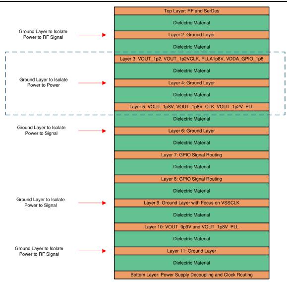
图 8-2. AFE79xx 堆叠和接地隔离层
