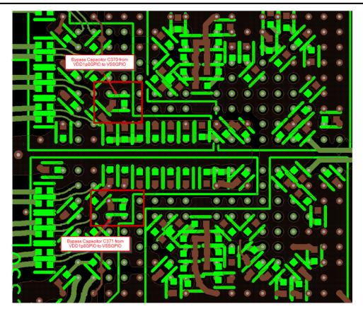
图 6-5. 与 DGND 切断相关的 VSSGPIO 焊球和 VDD1p8GPIO 旁路电容器
