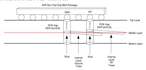
图 4-1. 中间层的过孔残桩效应
