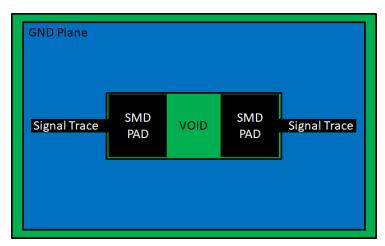
图 11-11. 空洞低于表面贴装器件
