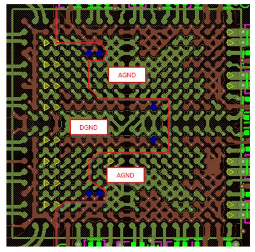
图 6-4. 与 DGND 切断相关的 ESD\_GND 焊球(显示为蓝色)
