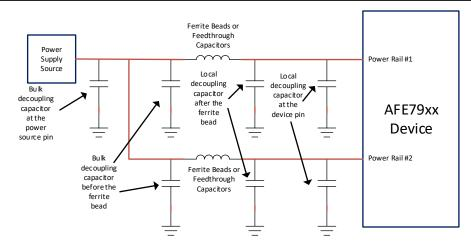
图 5-5. 适合分隔电源轨的铁氧体磁珠和旁路电容器的典型放置方式
