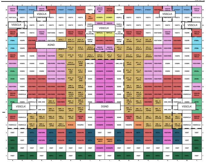
图 6-3. DGND、AGND 和理论 CLK 接地区域与 AFE79xx 引脚映射。
