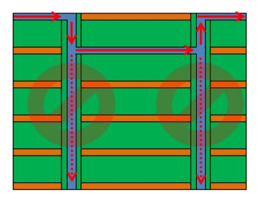
图 11-5. 避免使用:具有长残桩的过孔
