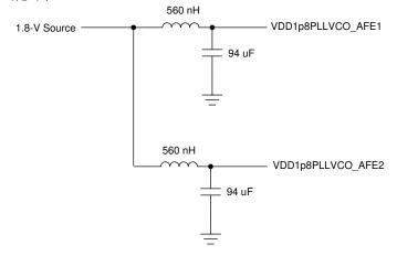
图 6-9. 电源网隔离滤波器
