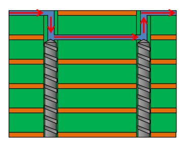
图 11-7. 使用:带有背钻残桩的长过孔
