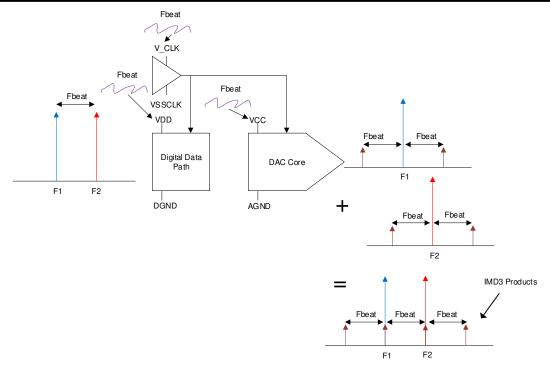
图 6-6. 双音输出的自耦合影响 TXDAC 的 IMD3 性能
