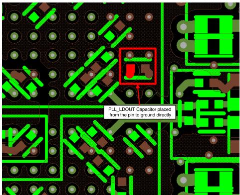
图 6-8. PLL\_LDOUT 0.1μF 电容器从引脚 J19 (PLL\_LDOUT) 路由到引脚 J18 (VSSPLLCLKREF)
