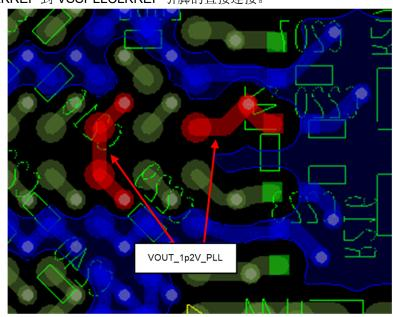
VOUT 1p2V PLL 布置在顶层,可最大限度地减少去耦路径所用的过孔数量。
