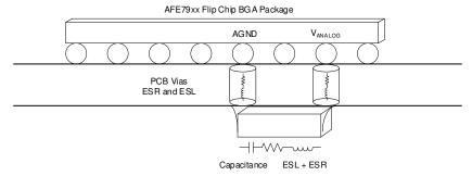
图 7-1. 由于电容器封装 ESL 和 ESR 以及过孔 ESL 和 ESR 产生的去耦电容器限制
