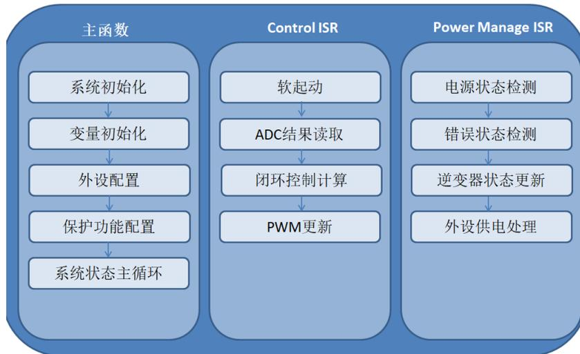
Figure 6. 系统软件架构图
