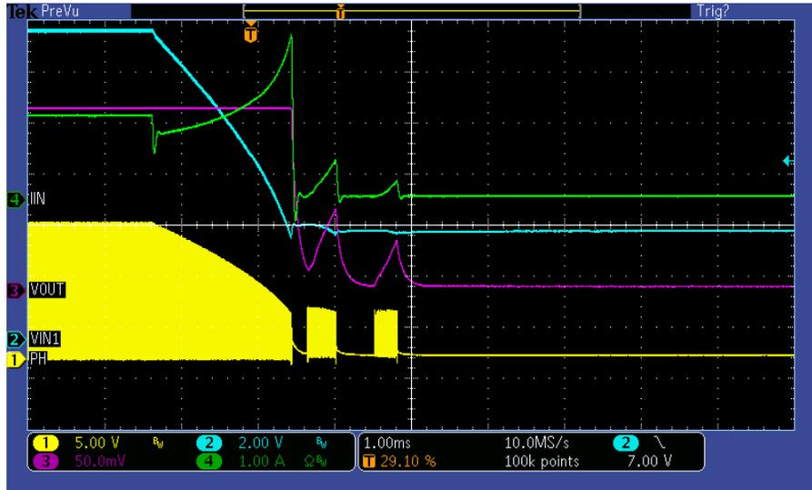
Figure 1. 掉电输出电压重启现象
