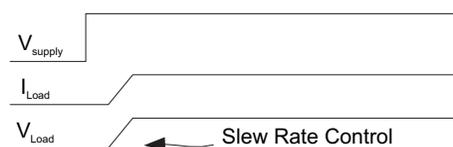
图 7. 使用负载开关的转换率控制
