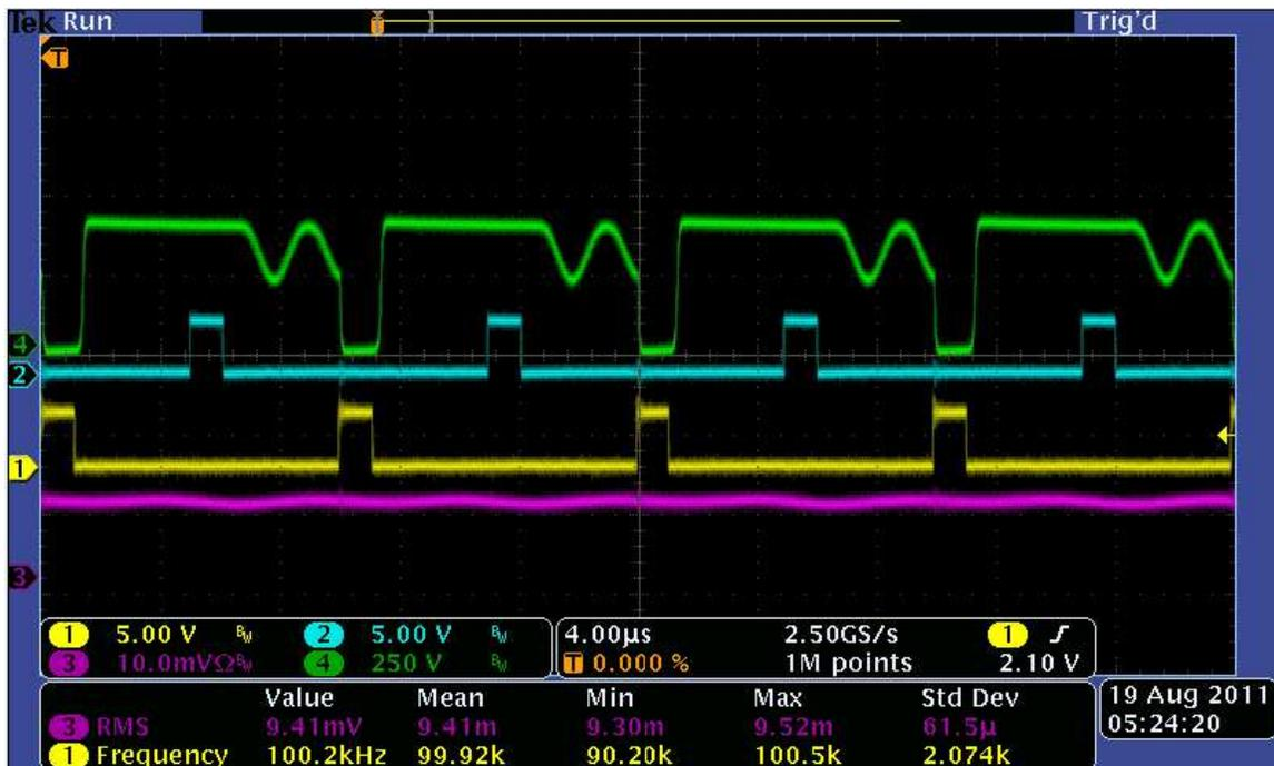
图 11. 交错式升压 DC-DC 波形
