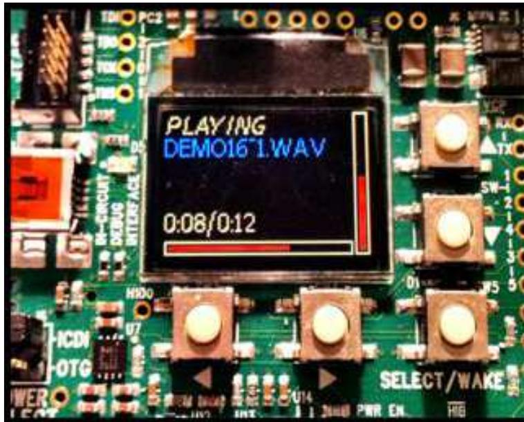
图 5. 双 SPI 软件示例 GUI
