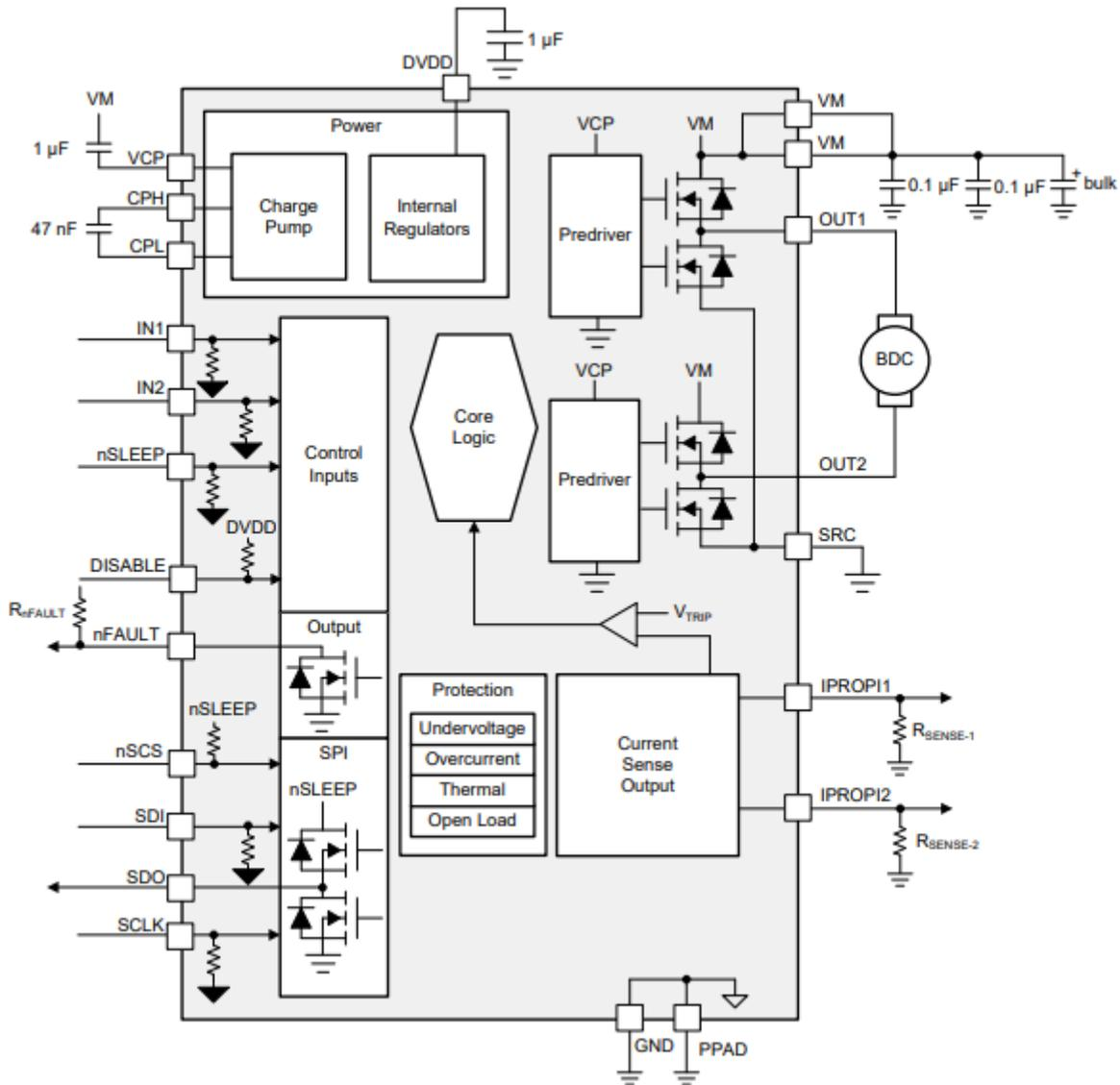
Figure 2-3. DRV8873-Q1 Block Diagram
