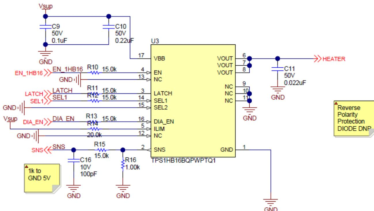
Figure 2-9. TPS1HB16-Q1 Configuration Schematic
