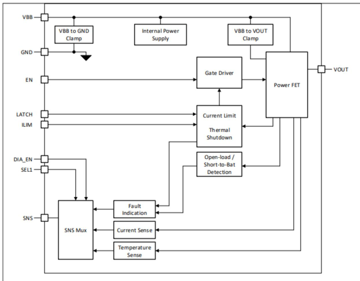
**Figure 2-4. TPS1HB16-Q1 Block Diagram**
