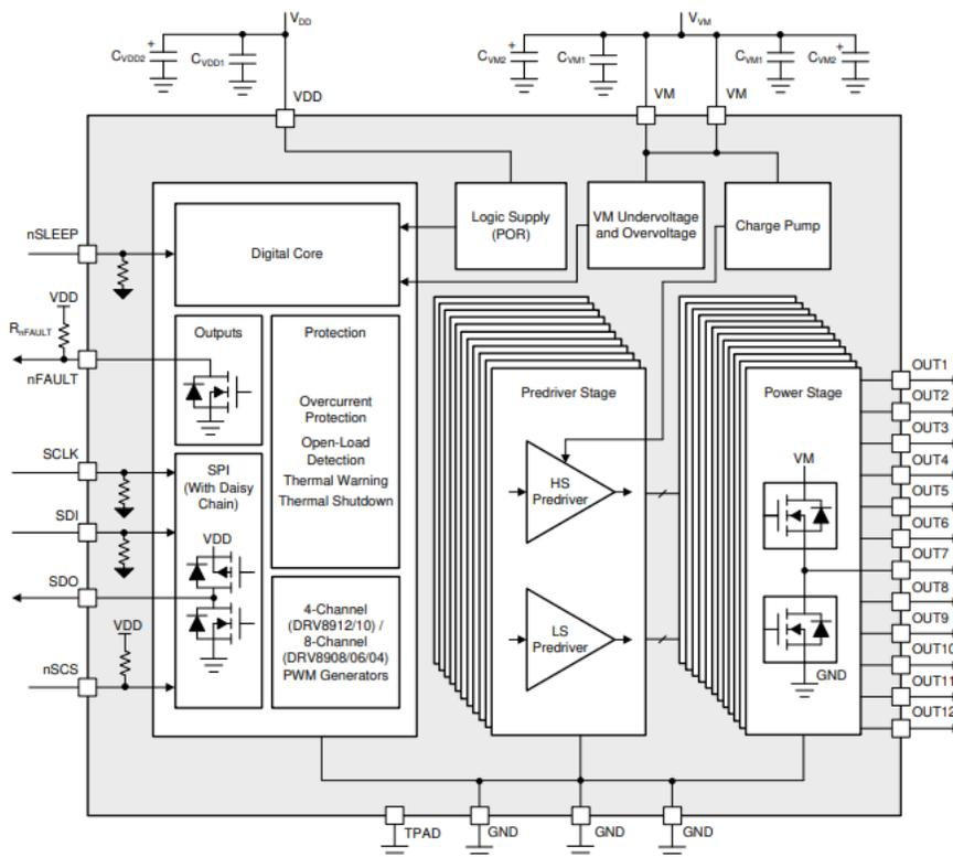
**Figure 2-2. DRV8906-Q1 Block Diagram**
