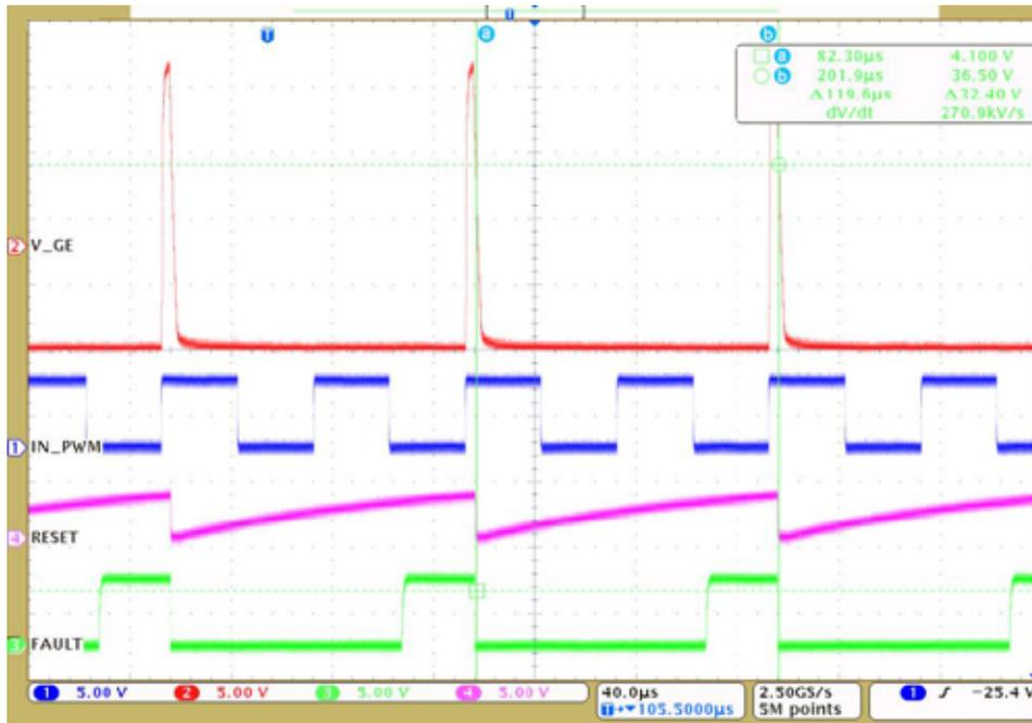
Figure 16. Auto-Reset Waveforms
