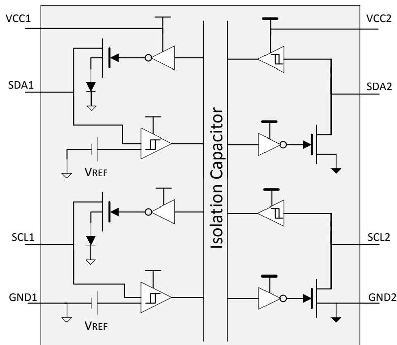
**Figure 12. ISO1541 Block Diagram**
