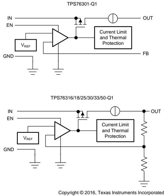
**Figure 10. TPS76350-Q1 Block Diagram**
