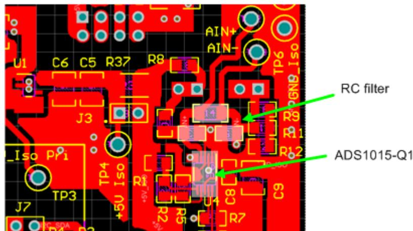
Figure 121. Placement of RC Filter and ADS1015-Q1
