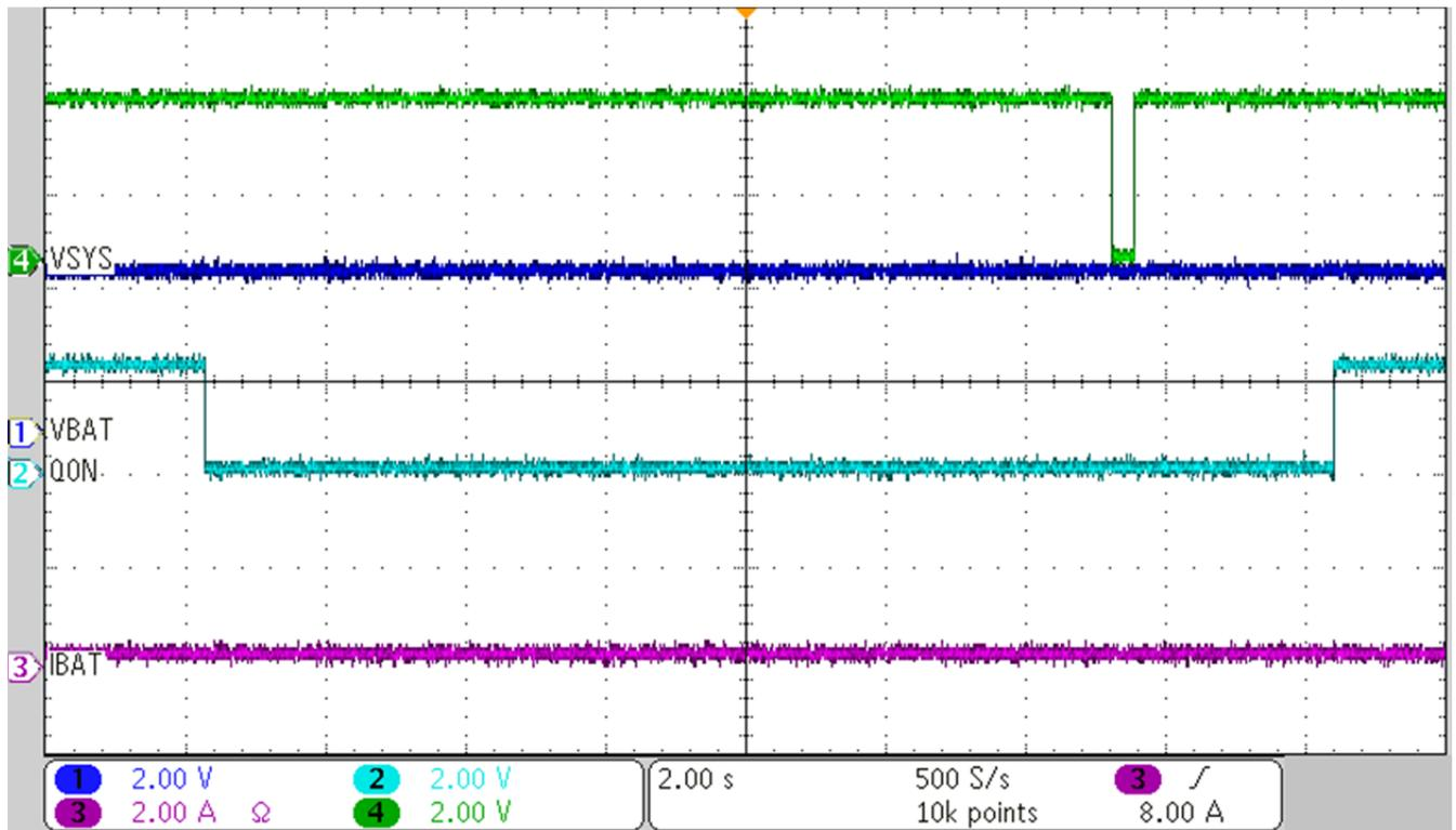
**Figure 7. TIDA-00591 BATFET System Reset**
