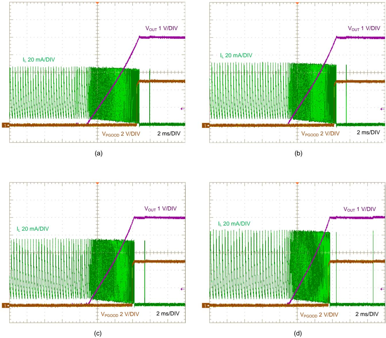
Figure 10. Short Circuit Recovery into No Load: (a)  $V_{IN} = 12\text{ V}$ , (b)  $V_{IN} = 24\text{ V}$ , (c)  $V_{IN} = 36\text{ V}$ , (d)  $V_{IN} = 65\text{ V}$
