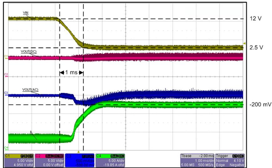
CH1: VIN 5V/div      CH2: VOUT(DC) 5V/div      CH3: VOUT(AC) 500mV/div      CH4: IL 5A/div
