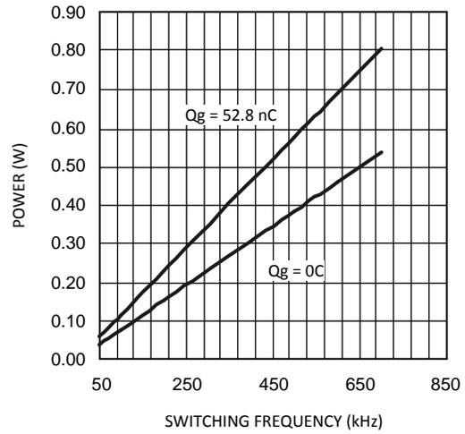
**Figure 4. Internal-Diode Power Dissipation**
