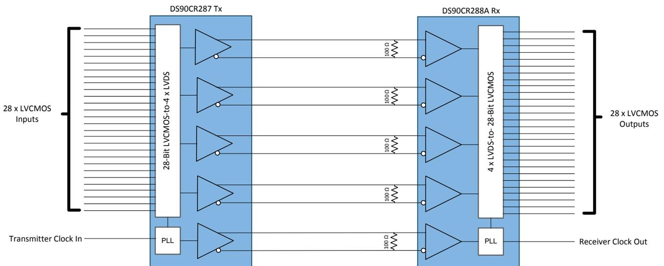
Figure 7. Connection Diagram for DS90CR287 to DS90CR288A
