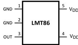
**Figure 3-1. Pin Diagram**
