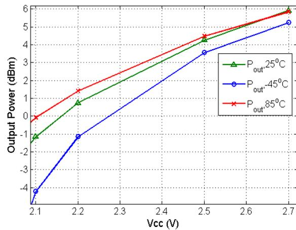
(d)  $V_{CC}$  vs output power
