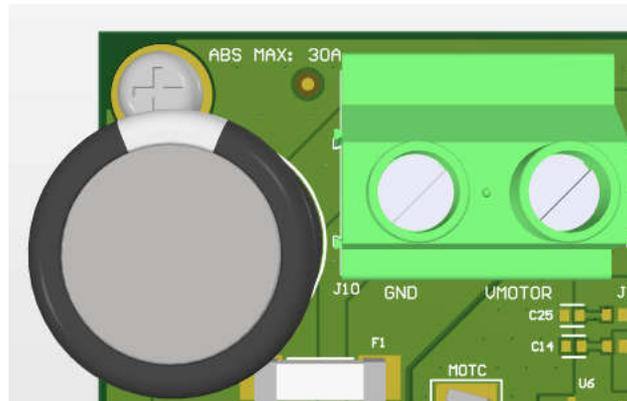
Figure 2-3. VMOTOR Input (J10)
