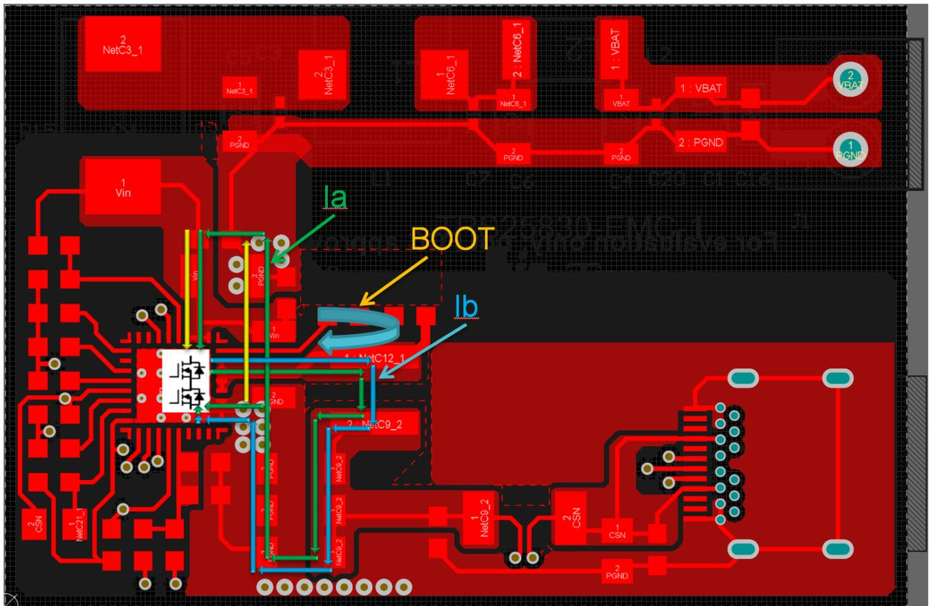
Figure 8. TPS2583X PCB Layout
