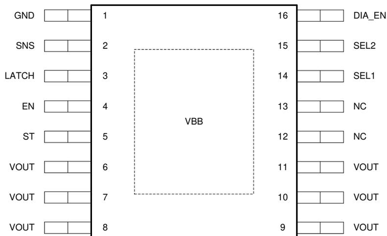
**Figure 4-1. Pin Diagram**
