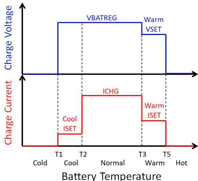
**Figure 3. BQ25619 Adjustable JEITA Temperature Profile**
