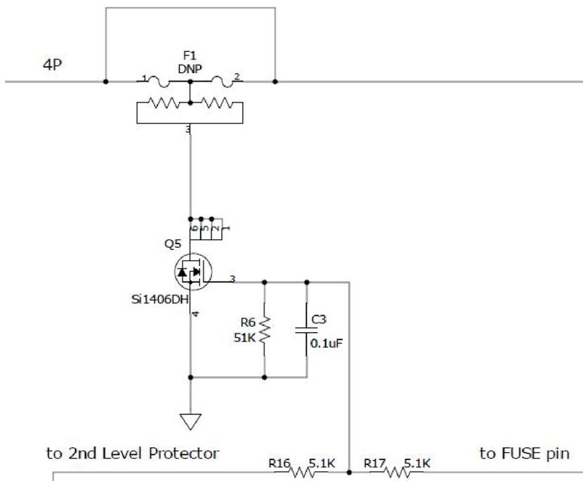
**Figure 10. FUSE Circuit**
