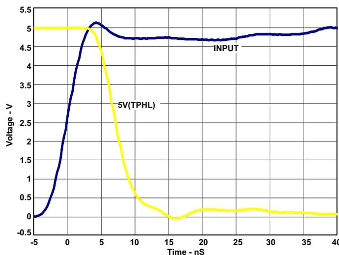
Figure 18.  $T_{PHL}$  5V 1K $\Omega$  pullup = 7nS
