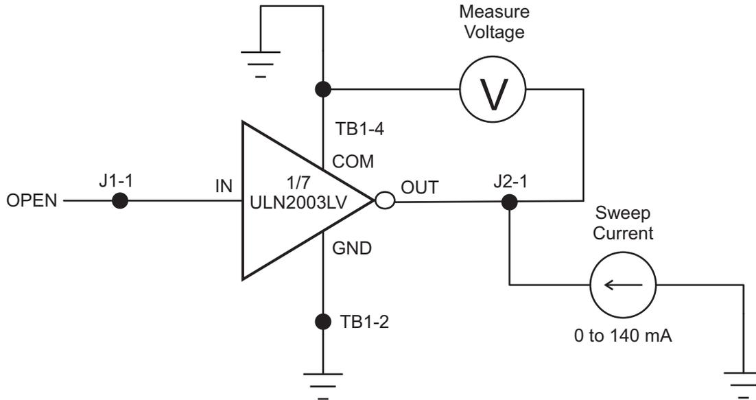
Figure 22. VF Schematic
