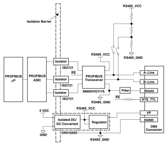
Figure 10. PROFIBUS Node Block Diagram
