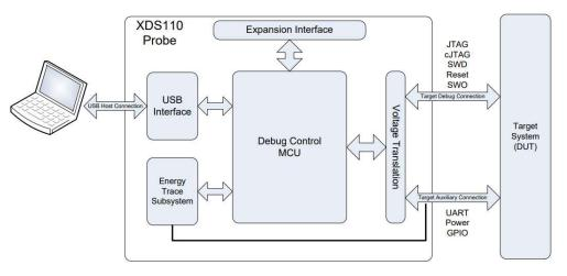
Figure 5-4. XDS110 Probe High-Level Block Diagram
