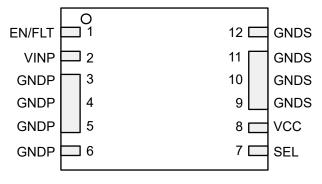
Figure 4-1. Pin Diagram (VSON-12) Package
