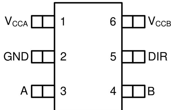
**Figure 4-1. Pin Diagram**
